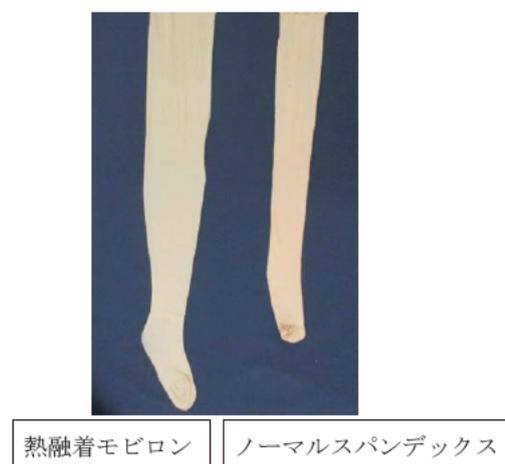
図 3. 洗濯 3 回後のストッキングの形状変化
