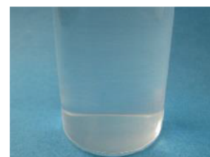
Fig.4 NCF(CNF/EVOH=1/5)の 分散性評価
