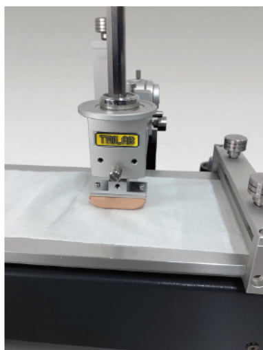
指紋パターンを再現した接触子で触覚を測定
